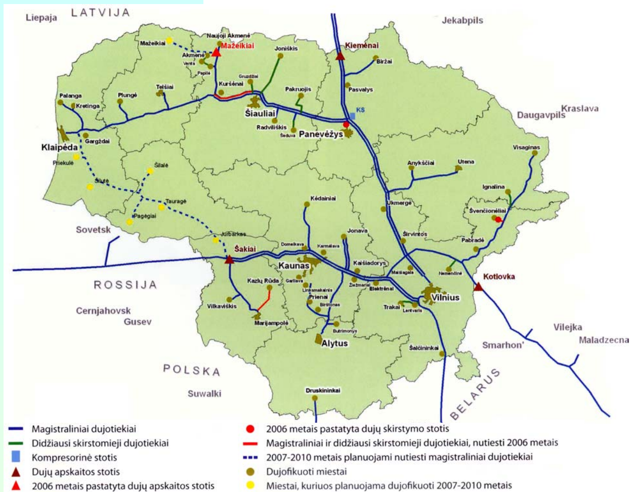
16.1 pav. Lietuvos dujų tiekimo sistemos tinklų schema
